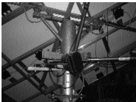
Foto 4.7. “Gjiresol FV” di 0,5 KW: particolâr dal sisteme mecanic di moviment (par concession de societât Enerpoint srl Milan).
