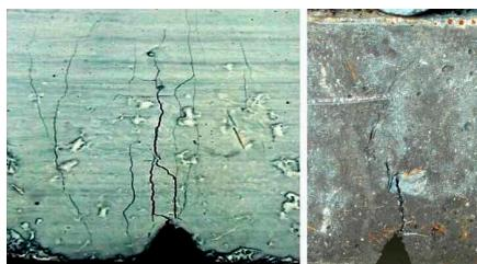
Figure 4. Dams tipics daspò di provis di resistance a la fadie; chei di çampe a son une vore pluï frecuentes di chei di drete.
