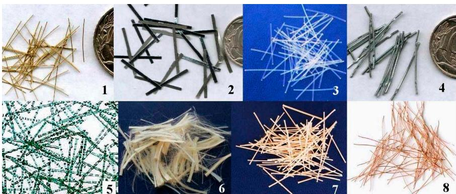
Figure 3. Difarents filiots doprâts par fâ RPM : 1-açár trafilât, 2-ghise amorfe, 3-nylon, 4-açár par bertuelis, 5-poliester, 6 e 7-twaron, 8-ram incrudît.
