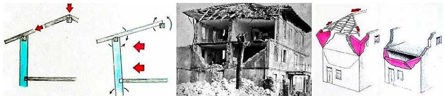
Figure 11. Efet negat f di un tet che al sburte f r.
