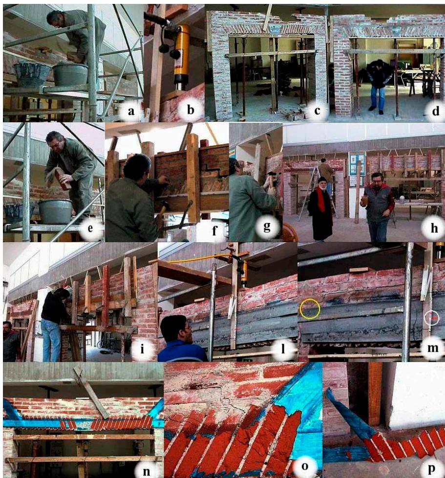
Figure 6. Confront jenfri RPM e resine rinfuarçade tal riscat struturâl di muraduris discloeadis.
