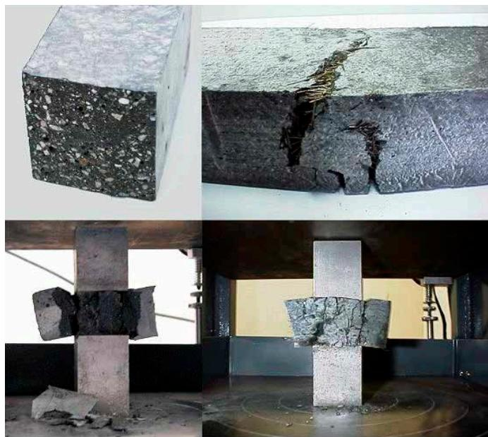
Figure 1. Roture a flession e a compression di une malte (a çampe) e di une RPM (a drete).
